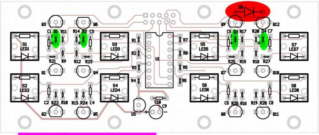
(12) BC550C transistor – note orientation 9. 0000 0 0 0 89 Q12 **Q**3 86 D1 R11 C5 D3 R17 14 17 |+ • 1<u>+</u>‡ ŧ‡ŧ R1 🖡 \$ R7 þ S1 LED1 S3 LED3 S5 LED5 S7 LED7 R2 \$ ŧ **₿ R8** ¢ ¢ N D Þ 0 <sup>™</sup> ----R18 R27 U1 R12 R15 R3 🎗 \$ R5 0 97 01 918 04 3 -\$ R6 ⊐ R4 🛊 S6 LED6 S2 LED2 S4 LED4 S8 LED8 11 ţţ ¢ ¢ ¥ **†** † ų N C10 C2 R22 R10 R13 R24 C4 R19 R28 C8 6 **R16** 82 811 95 88 113
